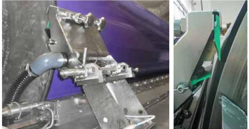
Produktionsbedingt muss der Strichauftrag breiter als die Papierbahn sein. So kommt es im Randbereich der Walzen zu „überflüssig“ aufgetragenem Strichmedium, das es zu entfernen gilt, um den Produktionsbetrieb nicht zu beeinträchtigen.
