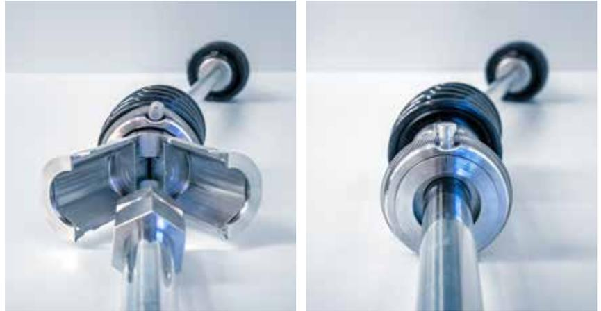
In einigen Anwendungsfällen ist es sinnvoll, einen flexiblen Rakelantrieb zu verwenden. Beispielsweise, wenn es aus technologischen Gründen nötig ist, häufig verschiedene Rakeldurchmesser einzusetzen. Oder, wenn sich die Grundkonstruktion des Auftragswerks nicht für einen Direktantrieb eignet.
