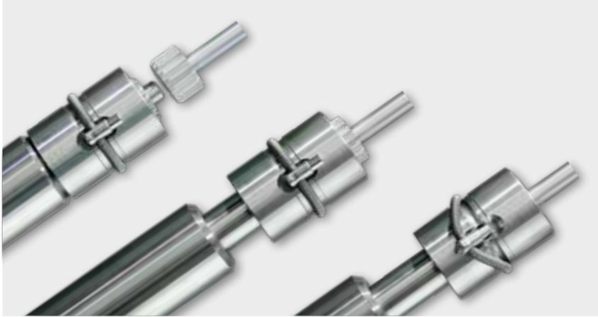
Unser hundertfach bewährter Direktantrieb ist vermutlich der zuverlässigste Rakelantrieb überhaupt – denn er kommt ganz ohne verschleißanfällige und schmutzempfindliche Komponenten aus. Insbesondere der Wegfall der üblicherweise eingesetzten Wellengelenke führt oft zu einem störungsfreien Betrieb über viele Jahre.
